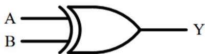
รูปที่ 2.22 เอ็กส์คลูซิฟออร์เกต (X-OR gate) [14]
