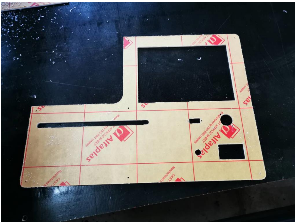
ภาพที่ ค.6 ภาพของแผ่นอะคริลิกหลังจากผ่านการกัด
